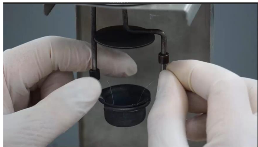
上移螺帽，燃烧丝一端卡入刻痕处，再下移螺帽，旋紧固定燃烧丝
